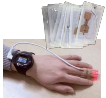
Zuurstof meten via een pleister om de vinger, die verbonden is met de SASense S18 saturatiemeter.
