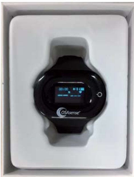
De OSAsense S18 saturatiemeter slaat de gemeten data op. Hierdoor wordt slaapapneudetectie met hoge nauwkeurigheid mogelijk en ontstaan nieuwe mogelijkheden voor onderzoek en diagnostiek.
